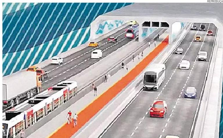
Com 1,5 quilômetro de extensão, sendo 870 metros submersos, túnel contará com três faixas por sentido
