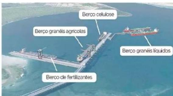
Na infraestrutura em água, haverá cinco berços de atracação, sendo dois para granéis de líquidos combustíveis, um para granéis sólidos de vegetais, um de celulose e um para granéis sólidos de minerais.
