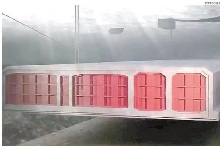
A estrutura será composta por seis módulos de concreto pré-moldados que serão mergulhados e vedados
