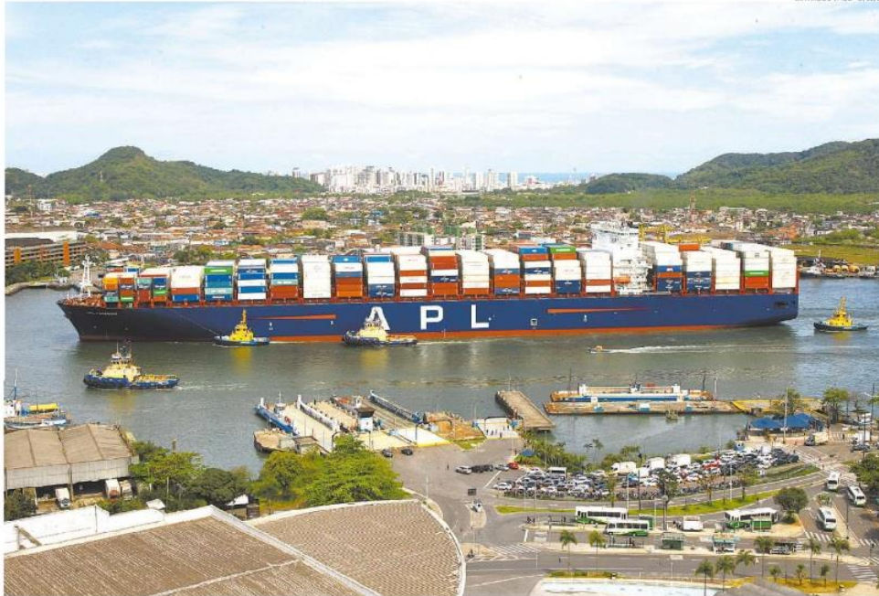
A homologação para navios maiores, de 340 metros a até 366 metros, é considerada para calados de até 14,2 metros, mesmo na maré alta
