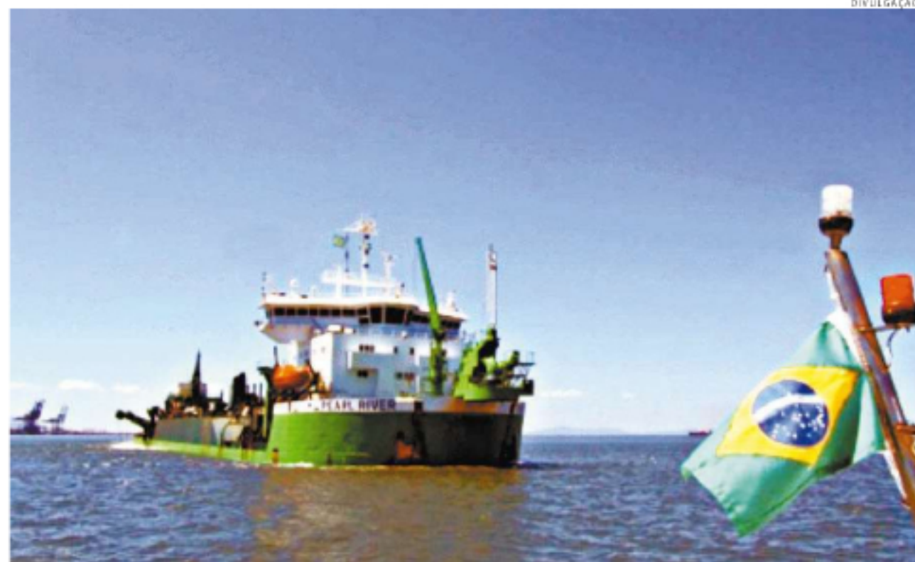
Draga tem capacidade para armazenar até 24.130 metros cúbicos de sedimentos em sua cisterna (porão)
